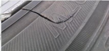
TODO MOTORISTA E CHEFE DE VIATURA DEVE FAZER A AVALIAÇÃO VISUAL DOS PNEUS ANTES DE REALIZAR QUALQUER DESLOCAMENTO. VERIFIQUE SE EXISTEM BOLHAS NAS LATERAIS, OBJETOS PRESOS E QUE POSSAM ESTAR PERFURANDO O PNEU, RACHADURAS, BEM COMO A CORRETA CALIBRAÇÃO.
